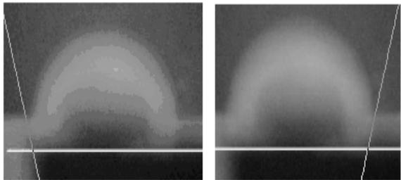
(d) B3 (0.6 mg/cm<sup>2</sup>) Angle 72° Angle 72°, Contact angle 108°
