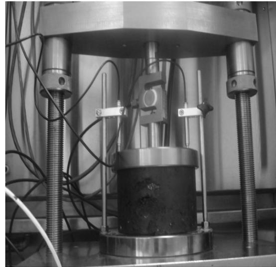
Fig. 3 Creep testing using UTM-5P
